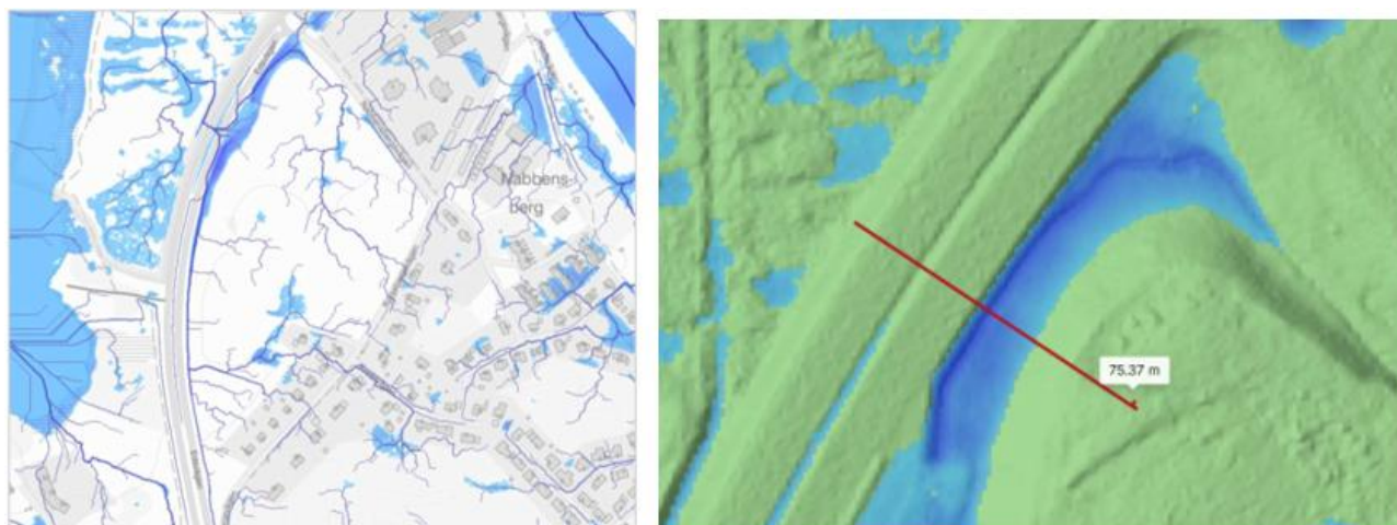
Figur 21. Vattensamlingar vid ett 100-årsregn, 50 mm (tv), dike intill Edsvägen (th). Källa: Afry, 2025.
