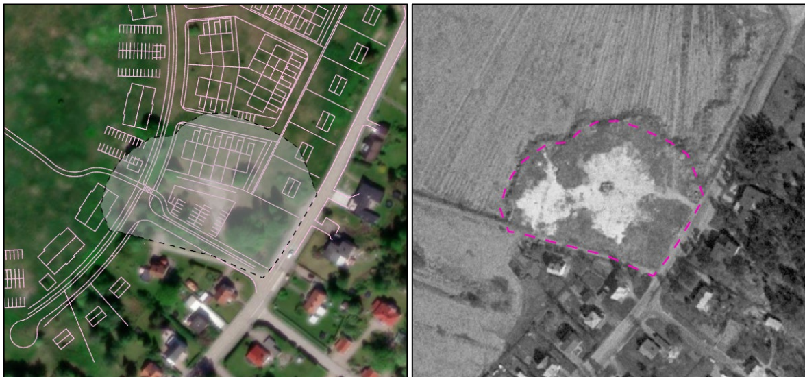
Figur 4. Uppskattat område som troligen är utfyllt med ferrokalk över planerad utformning (vänster) och flygfoto från ca 1975 (höger) (Lantmäteriet, 2025).
